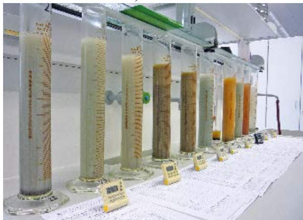
Schlammanalysen zur Ermittlung der Korngrößenverteilung
